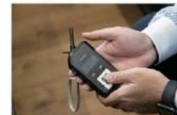
電気化学式のアルコールチェッカーとスマホを連携させ、確実な検査を実施
