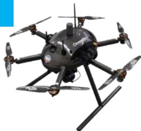
再現性の高い飛行撮影が可能な高精度位置情報を持つドローンを利用して構築した仮想空間に時間情報を付加することで、インフラ設備の長寿命化に向けた施設の経年劣化が把握できます。
